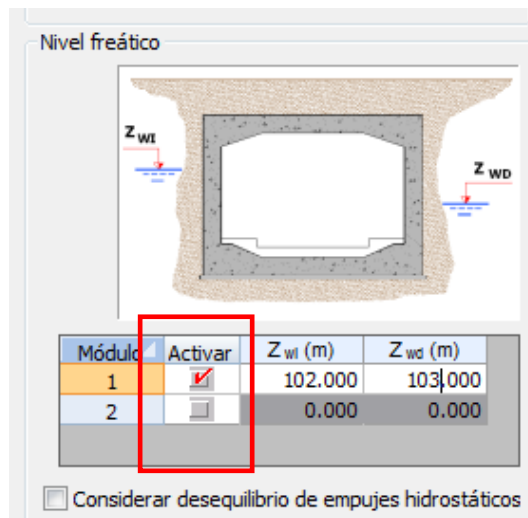
Figura 3.6.2.1-4: Definición de los niveles freáticos.
