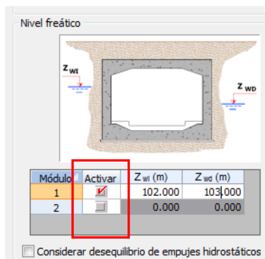
Figura 3.6.2.2-4: Definición de los niveles freáticos.
