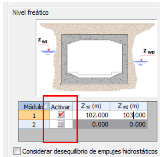
Figura 3.6.2.3-12: Definición de los niveles freáticos.
