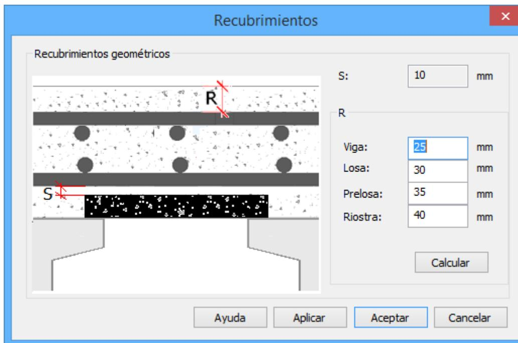
**Figura 3.13.1-1:** Ventana para la definición de los recubrimientos.
