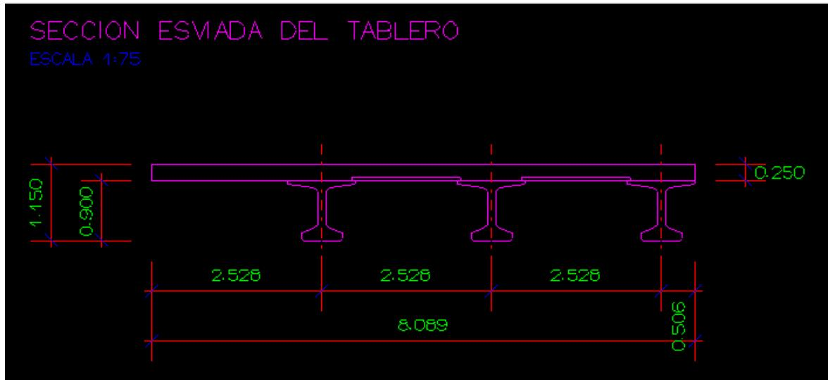
**Figura 5.2.1.5-1:** Figura *Sección del tablero*.
